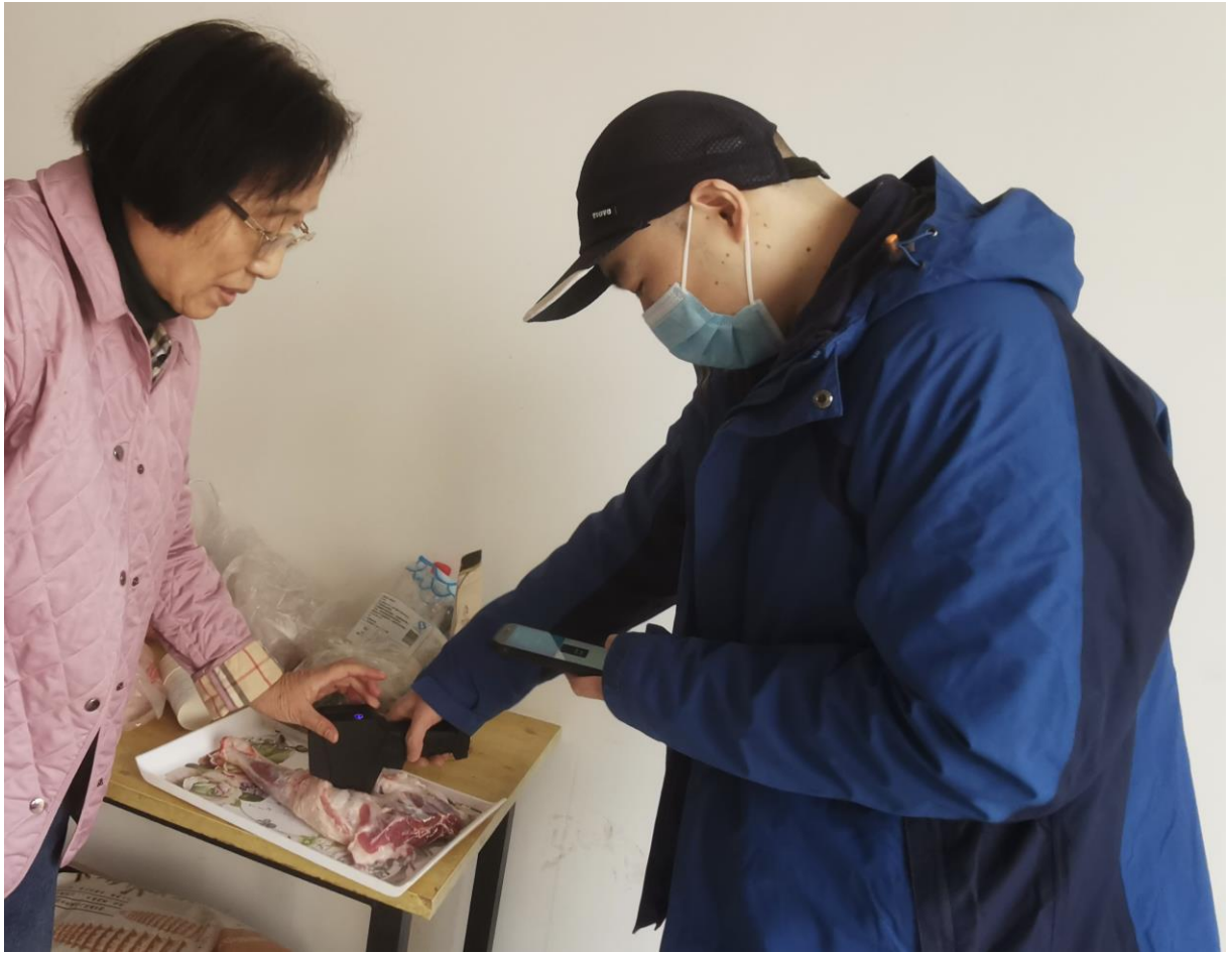
照片 14：应用遥感高光谱仪测试宁夏盐池滩羊肉新鲜度高光谱值 (2021 年 1 月 14 日，宁夏盐池县花马池镇皖记沟村)
